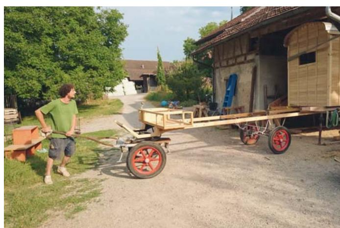
Le châssis a été révisé et équipé de nouveaux longerons, le chevalet a également dû être entièrement remplacé.
