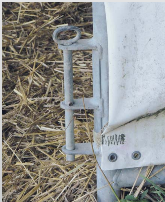
Fig. 1: Une aspérité comme celle-ci devrait être évitée pour prévenir les blessures. Abb. 1: Vorstehende Strukturen an der Einrichtung sollten vermieden werden, um Verletzungen durch Anstossen zu vermeiden. (SNG)
