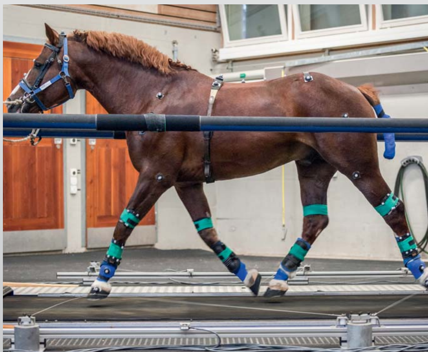
Fig. 1: Un étalon FM équipé trotte sur le tapis roulant. Les bandes élastiques reliées aux sabots servent au positionnement des sabots sur le tapis roulant, permettant de mesurer les forces exercées au moment de toucher le tapis.
