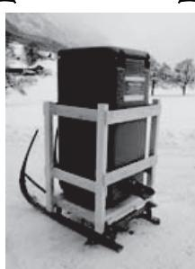
der frostsichere Wassertank, ohne Beheizung, stromunabhängig
