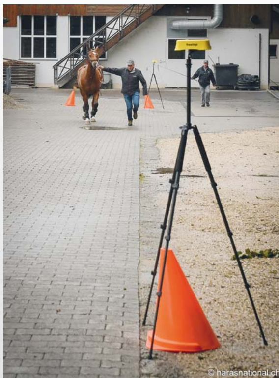
Figure 2: la vitesse du cheval était enregistrée à l'aide d'un chronomètre à barrière photoélectrique, Freelap (boîtier jaune).
