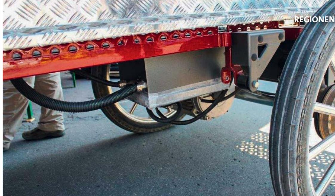
Coup d'œil sous la voiture avec le moteur situé directement sur l'essieu arrière
